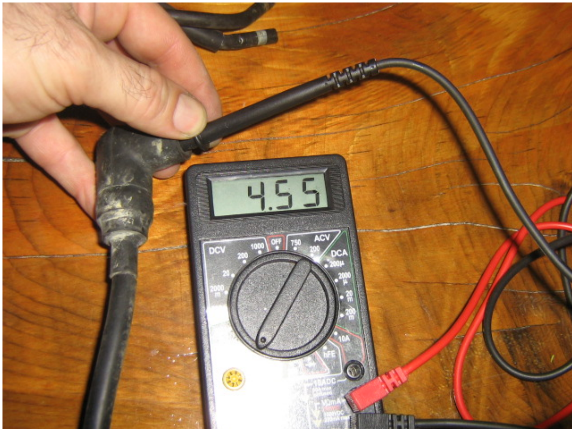
Cavo e pipetta #4: 4.55 k \Omega
