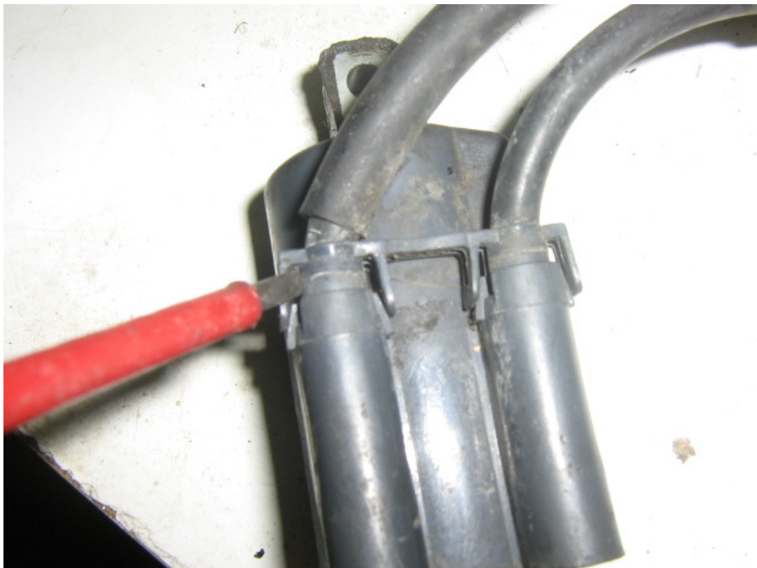
I vecchi cavi sfilati con annesse le molle di plastica.
