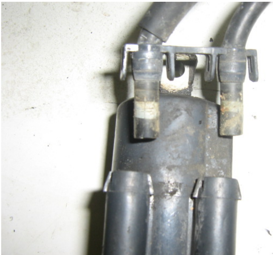
I vecchi cavi sfilati con annesse le molle di plastica.
