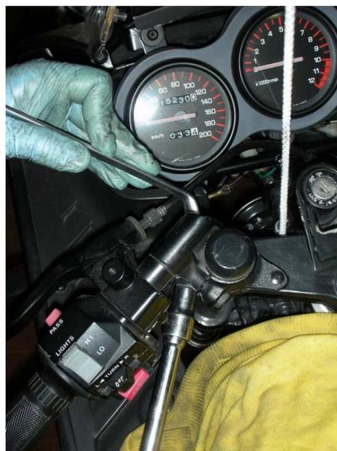
Una volta allentato il supporto superiore, si passerà ad allentare la morsa del supporto inferiore ("il cristo de sotto") tramite l'allentamento delle quattro viti a testa esagonale...
