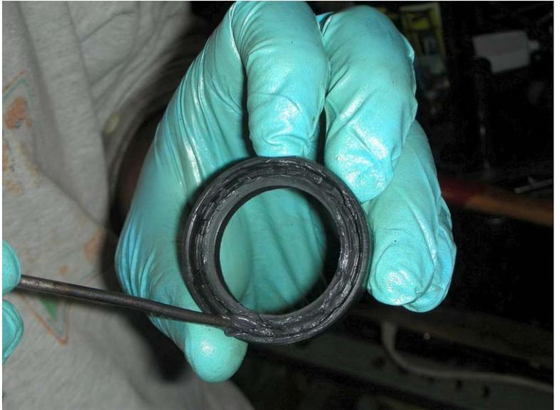
Dopo aver inserito anche la rondellona, passiamo al corteco, il quale dovrà essere infilato per il giusto verso, preferibilmente, con l'ausilio di un foglietto di plastica che aiuterà la salvaguardia dei lembi interni di tenuta del corteco
