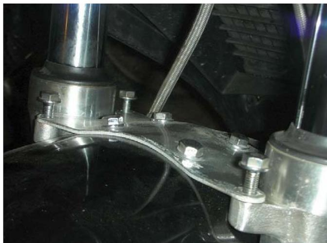
Fate molta attenzione quando sfilerete il parafango, non sembra ma non è un'operazione immediata anche perché, dovrete impedire che le plastiche di quest'ultimo vengano rigate.
