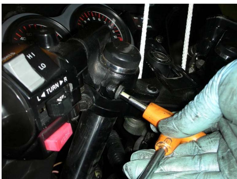
Dopo questo, passeremo ad allentare la testa esagonale della vite che assicura la tenuta del supporto superiore delle forcelle (volgarmente detto "il cristo de sopra").
