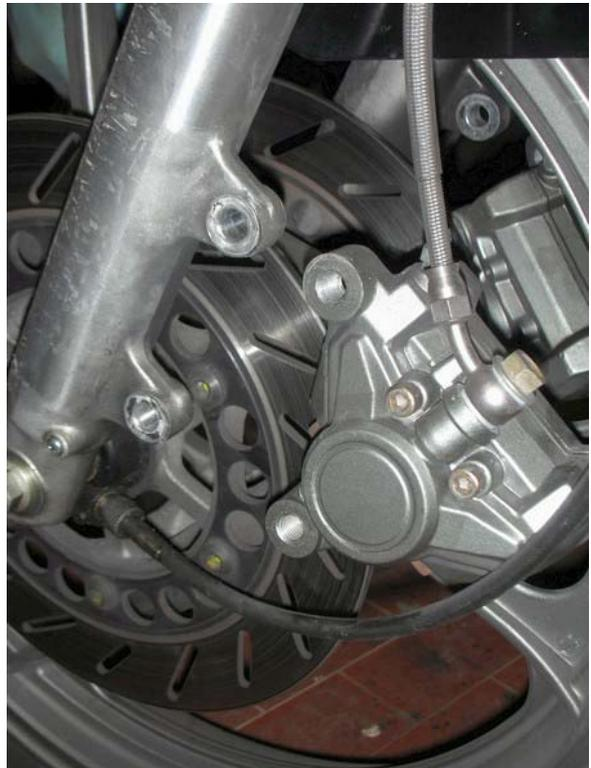
Ora, si passerà allo sfilare il perno della ruota anteriore svitando il dado dalla vite
