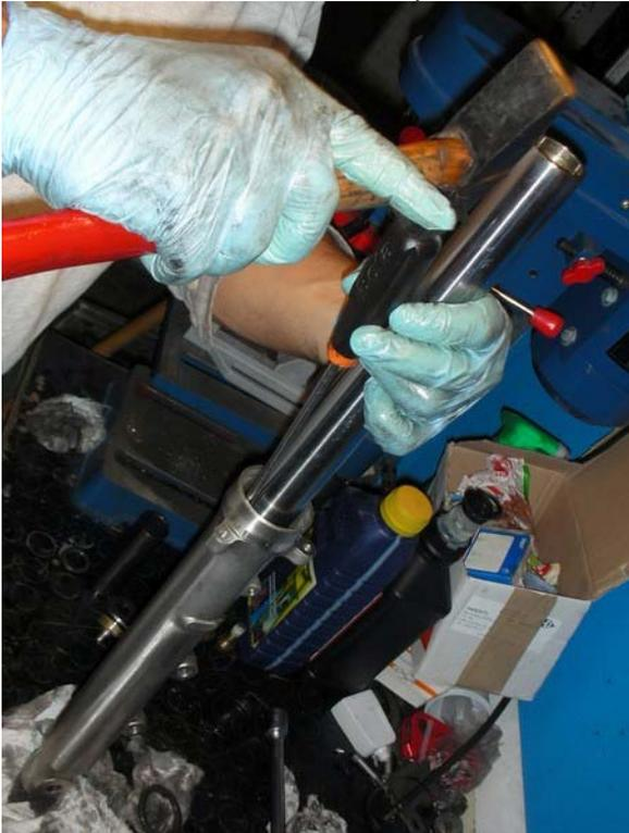
Subito prima di inserire il corteco, riempiamo di grasso entrambe i canali del corteco onde mantenere per un periodo più lungo la morbidezza della gomma dello stesso
